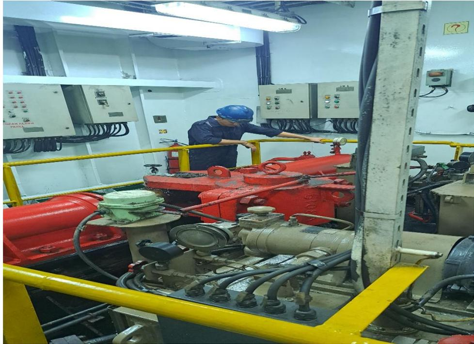
***Pengecekan Kebocoran Oli Pada Shaft Steering Gear***
