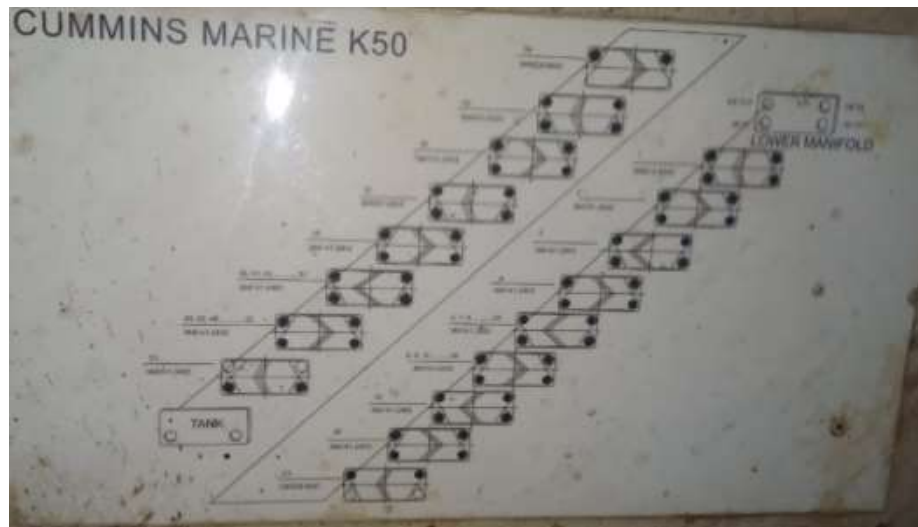
Gambar 3.4 Pemasangan Heat Exchanger yang benar
