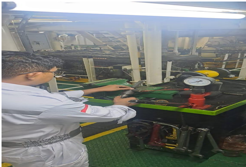
Gambar 3.5 : Foto saat pengetesan injector mesin induk
