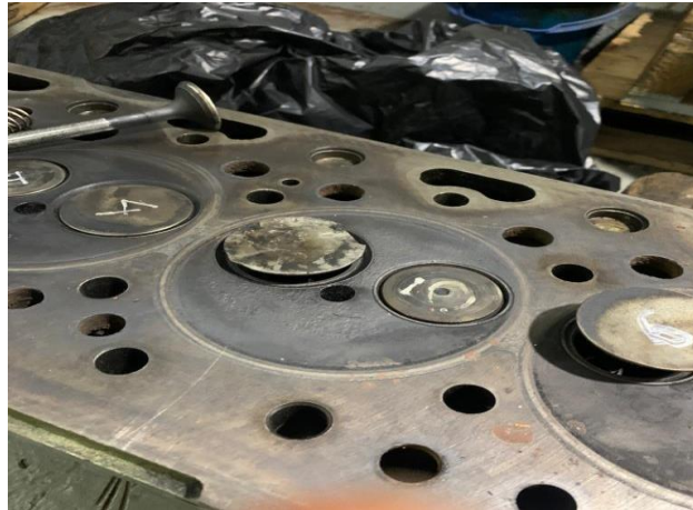
Gambar 4.3. Retaknya kepala katup pada silinder 2
