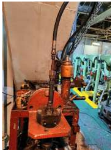
Gambar 3.7 : Pengetesan tekanan injector
