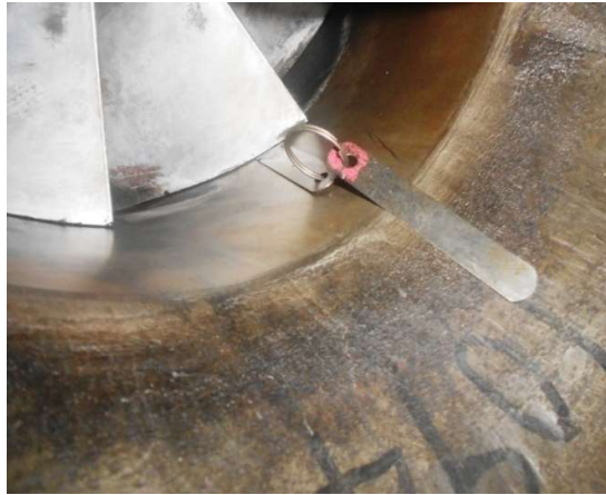
Gambar 3.1. Pemeriksaan roda kompresor
