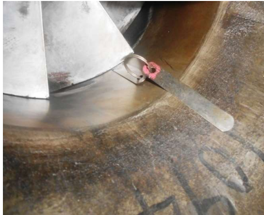
Gambar 3.1. Pemeriksaan roda kompresor
