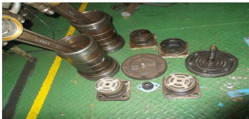
kurangnya perhatian dan perawatan yang terencana terhadap kompresor udara, seperti terdapat jelaga dan sisi karbon yang terbentuk dari minyak di kompresor udara.
