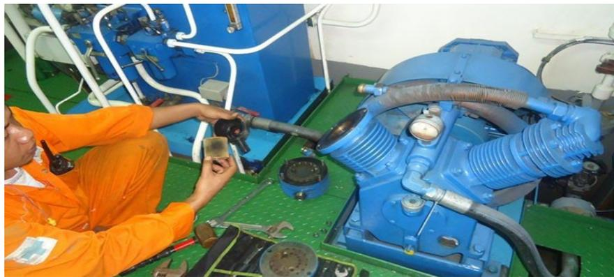
isap tekanan tinggi (*high pressure suction valve*), selanjutnya udara ditekan ke botol angin melalui katup *non-return valve*. Tidak maksimalnya kinerja kompresor udara dalam pengisian udara bertekanan kedalam botol angin disebabkan oleh kebocoran udara di kompresor.
