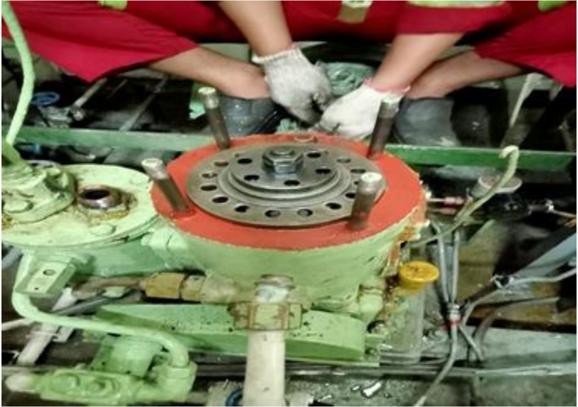
GAMBAR:OVERHAUL LINER LP KOMPRESSOR UDARA
