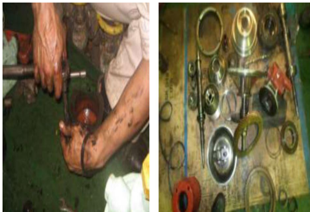
Pembongkaran LO Purifier
