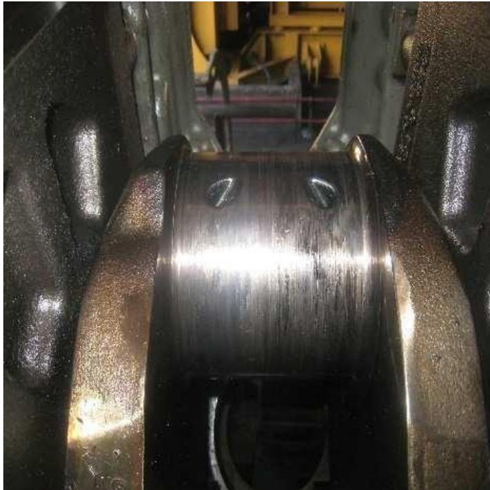
Gambar : *Crank Pin*
