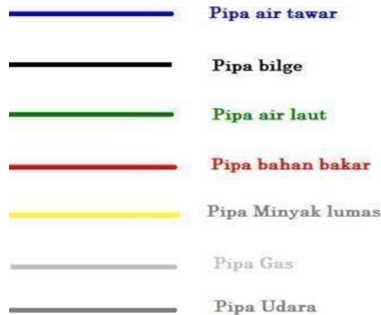
Gambar 2.1 warna – warna pipa di atas kapal
