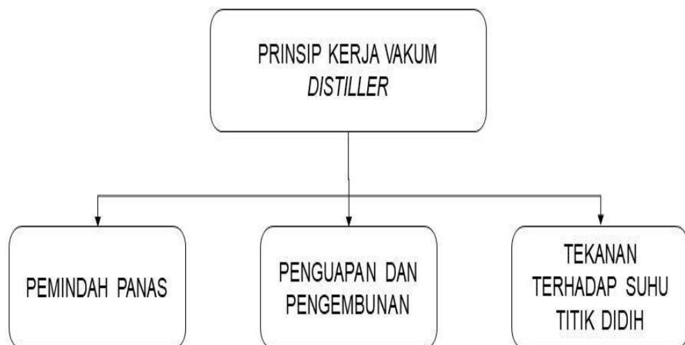
Gambar 2. 2 Prinsip kerja vakum distiller
