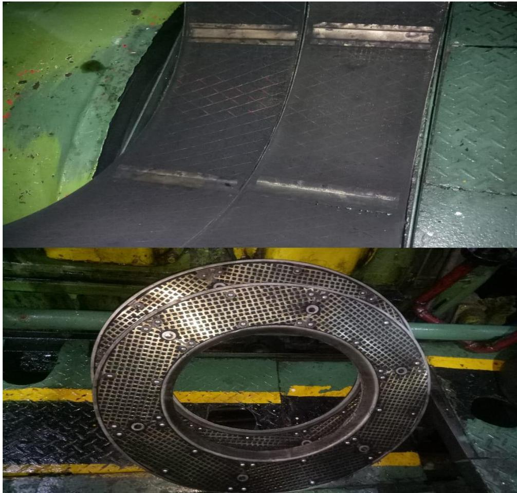
Gambar: Piringan Filter & Filter luar Turbocharger MV . SELARAS MAS
