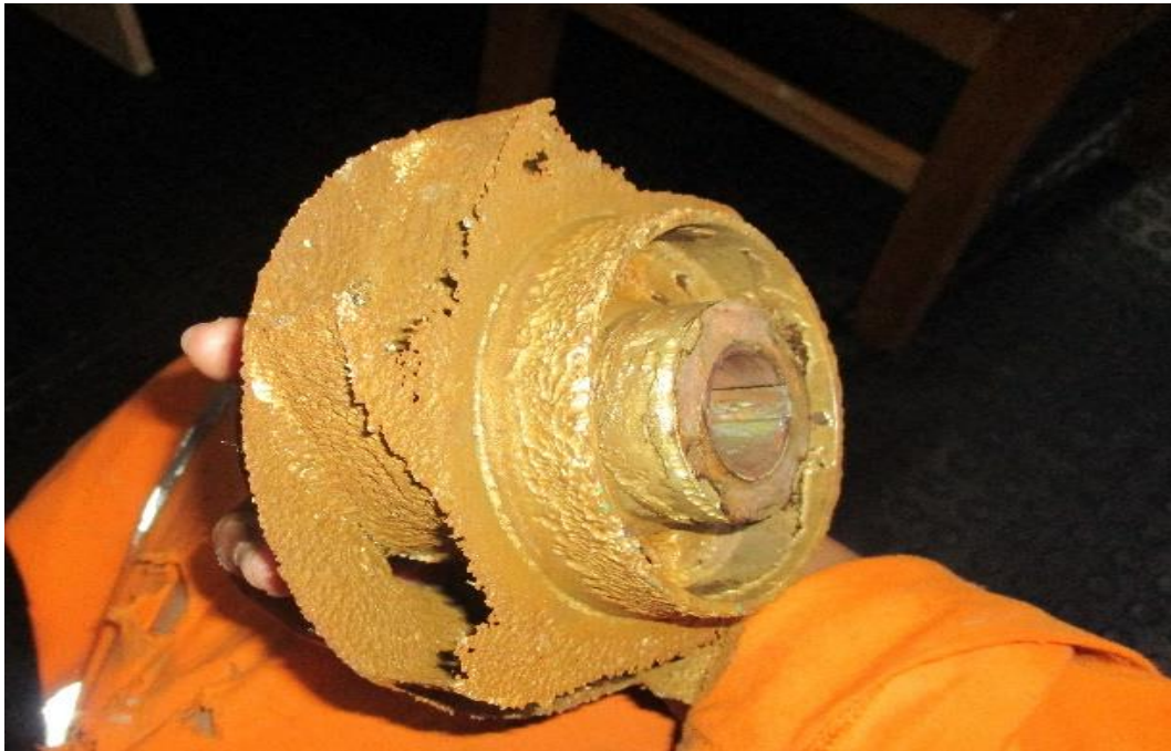
Impeller pompa yang aus
