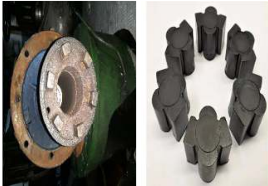
Gambar 3.9 : kondisi kopling dan spare rubber coupling yang baru pemecahannya adalah sebagai berikut :
