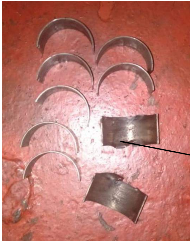
Lampiran 4 metal jalan yang rusak dan spare part baru
