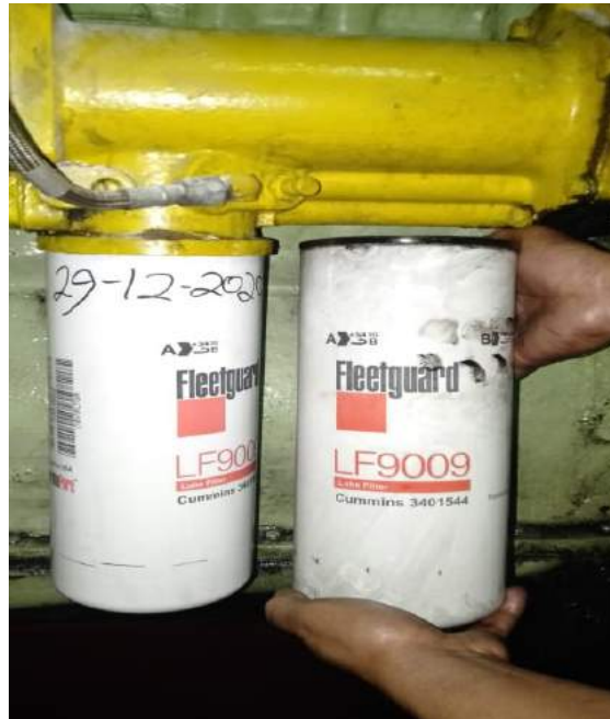
Gambar. 3.2. Gambar prosedur pembersihan saringan minyak lumas
