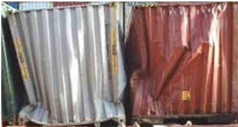
Gambar 3.1 Kontainer yang bergeser
