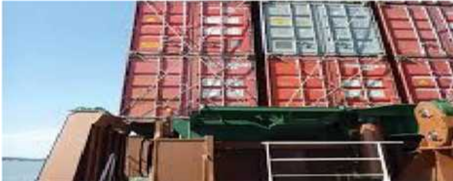
Gambar 3.6 Pelashingan tanpa menggunakan bridge fitting
