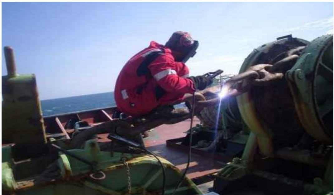
Gambar 4.3 Pelanggaran crew kapal saat kegiatan Deck Maintenance tidak memakai safety helmet ketika bekerja di deck kapal MT.IBM 1. Sumber : Kapal MT.IBM 1,tahun 2019
