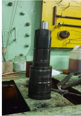
Gambar 4.1 Injektor KM. Mutiara Ferindo V
