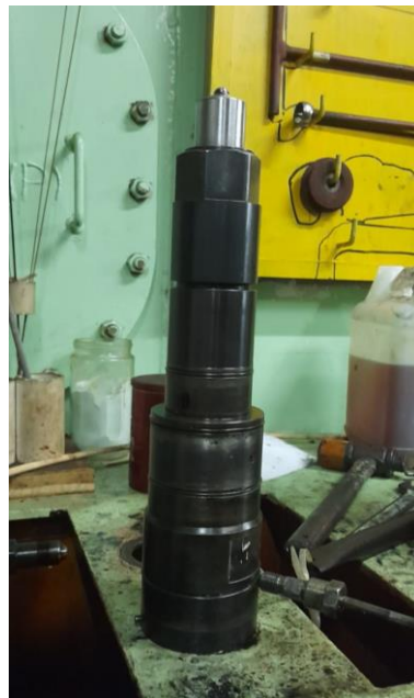
Keterangan : Pemasangan Komponen Injektor
