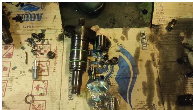
Gambar 4. 2 Membongkar bagian bagian injektor
