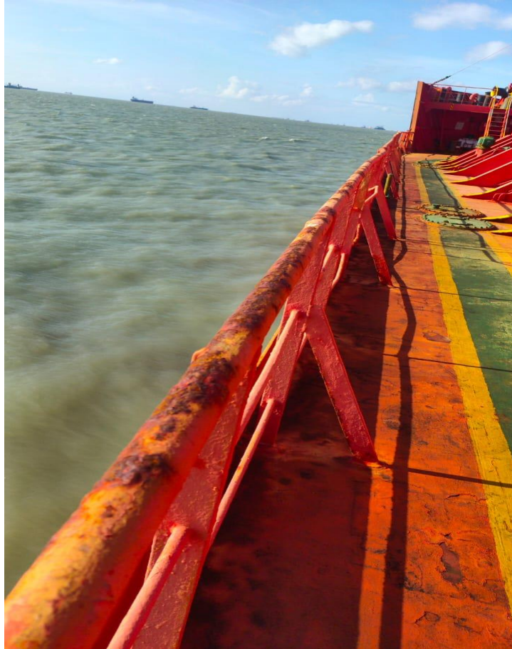
Gambar 2.1 Bentuk korosi pada main deck
