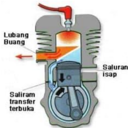
Gambar 2.6 Langkah ekspansi dan buang
