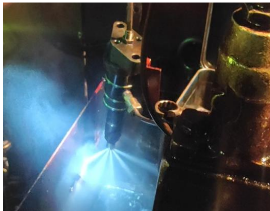
Gambar 4. 4 pengabutan sempurna pada injektor yang normal
