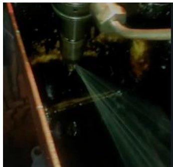
Gambar 4. 6 Kondisi nozzle yang retak
