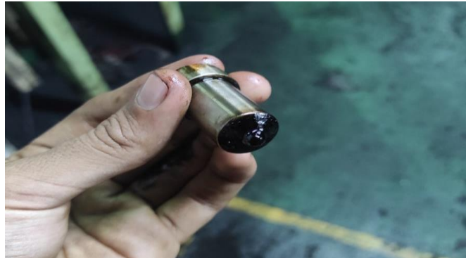
Gambar 4. 5 Terdapatnya sumbatan yang menumpuk pada lubang nozzle
