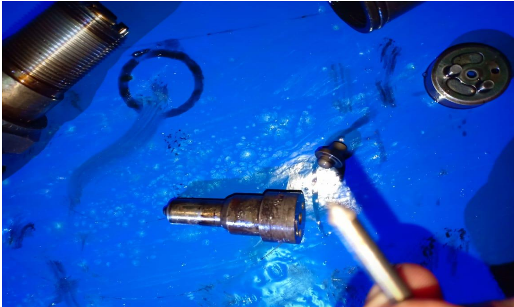
Gambar : Skir Jarum dan Bodi Nozzle yang Menetes Sumber : MV. Dian Prosperity
