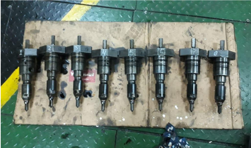
Gambar : Injector yang telah siap digunakan dari berbagai masalah
