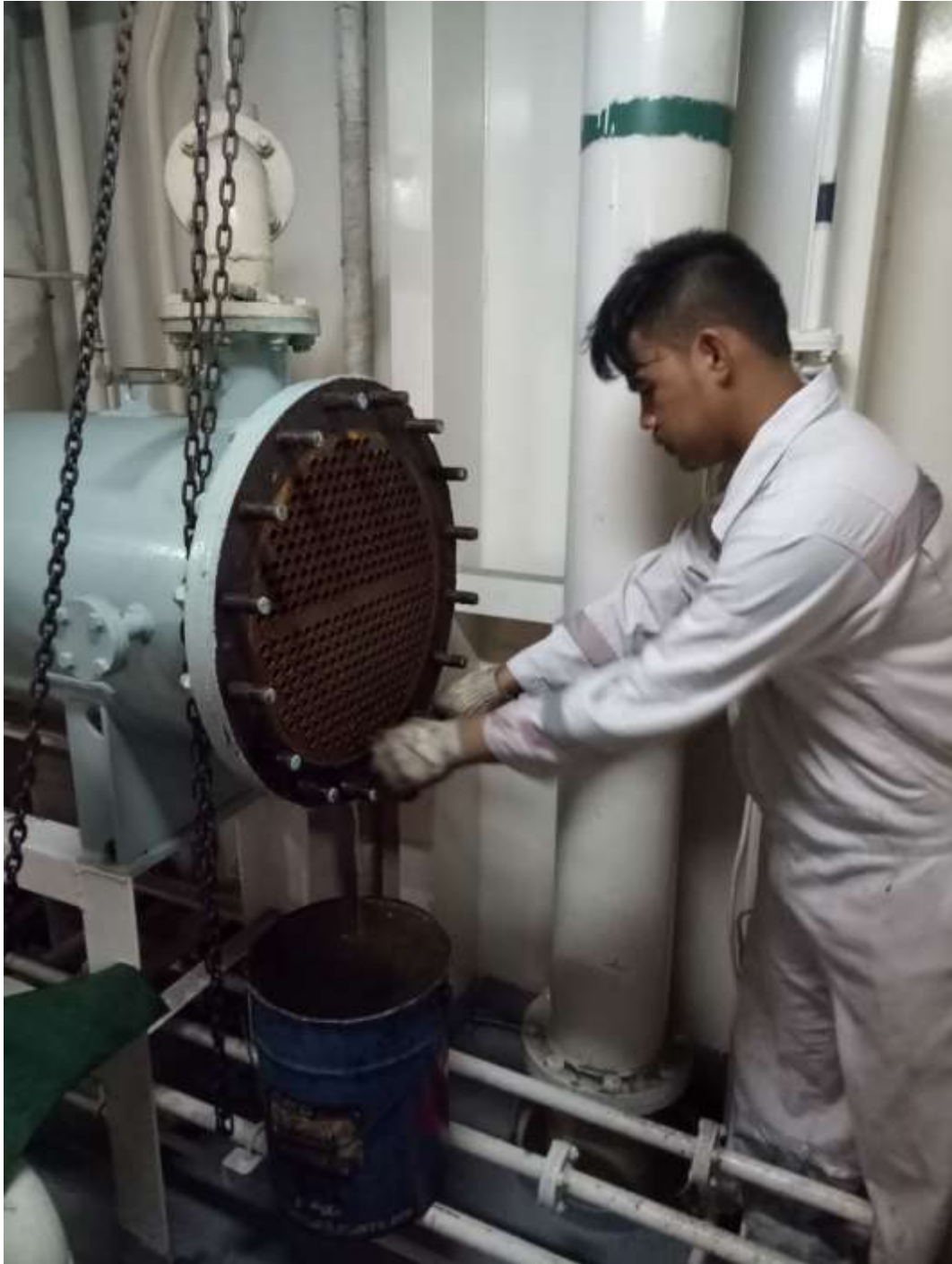
Gambar : Pembersihan Kotoran Pada Pipa Kapiler Sumber : KM. Dharma Kartika IX, 2021
