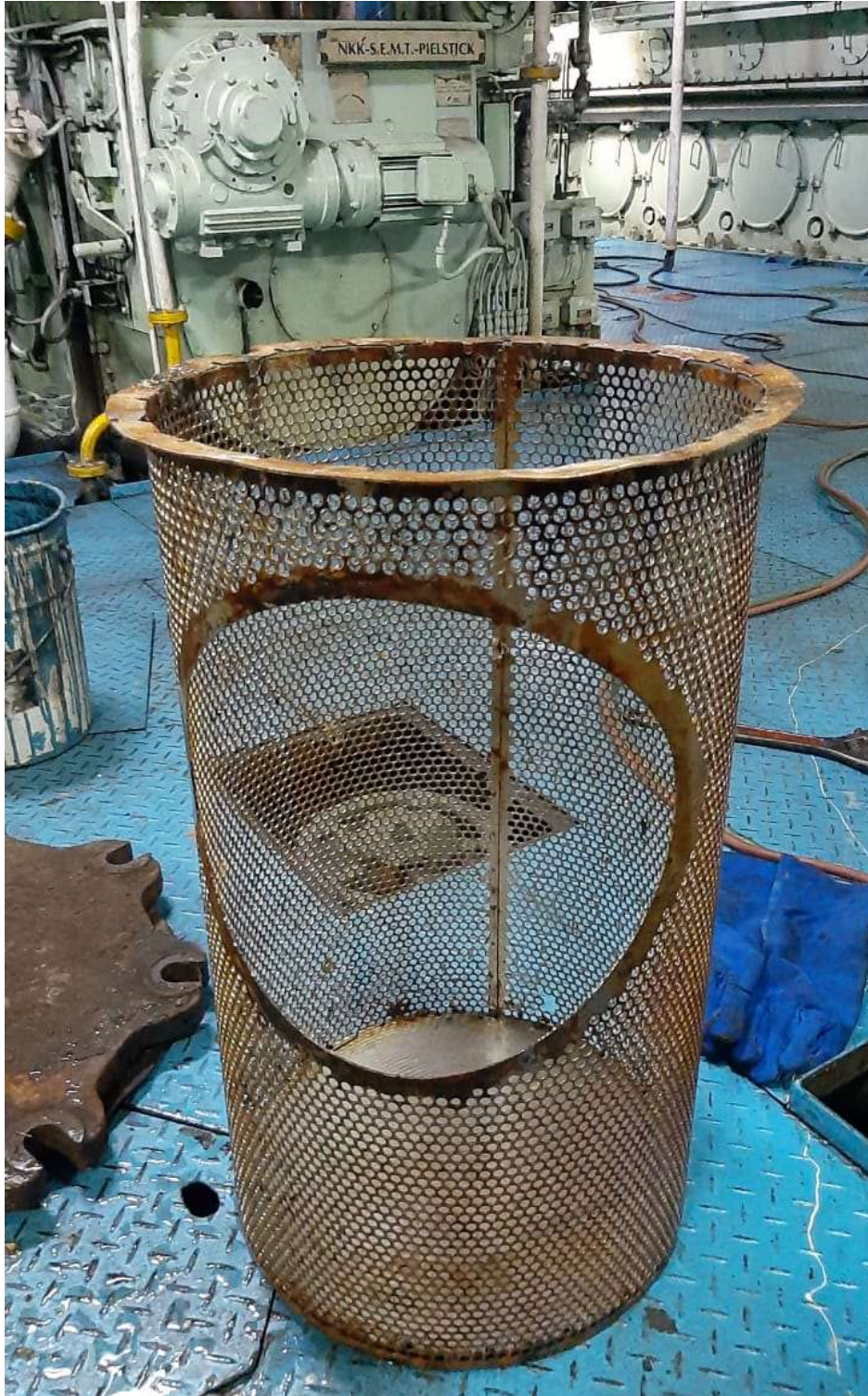
Gambar : Filter (Sea Chest) Setelah Dibersihkan Sumber : KM. Dharma Kartika IX, 2021
