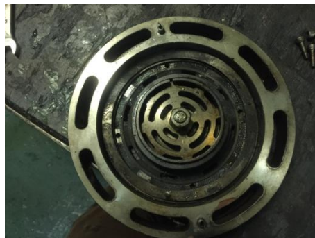
Gambar 4 5 Katub yang telah diperbaiki
