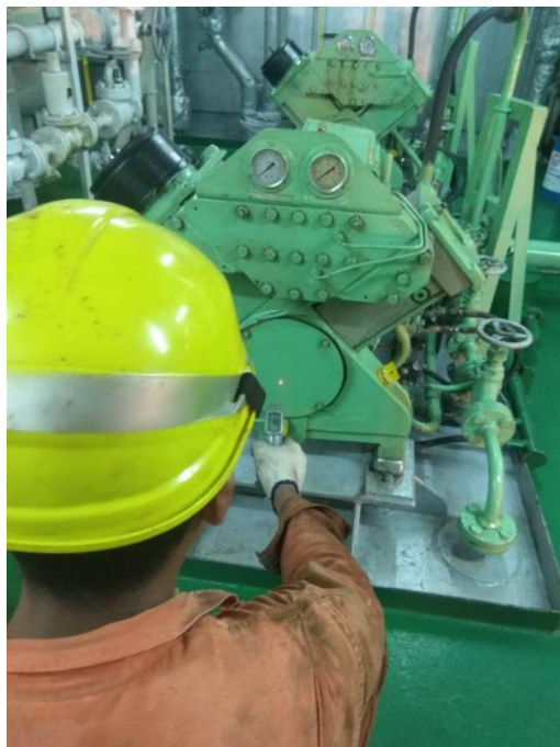
Gambar 4 1 Pengecekan Suhu Minyak Lumas Pada Carter
