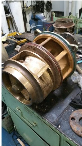
Gambar : pompa air laut
