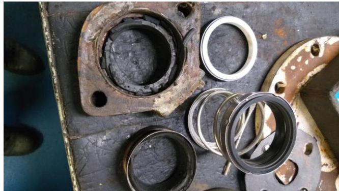
GAMBAR 4. 2 kondisi mechanical seal yang baru akan diganti
