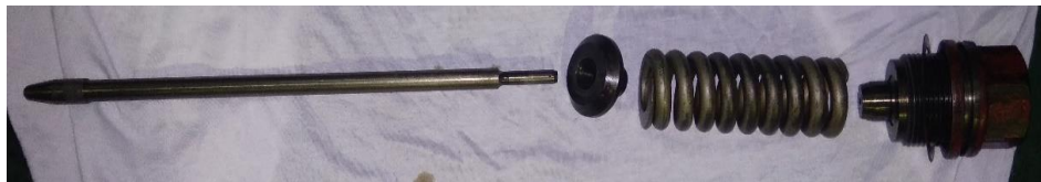
Gambar 4. 12 dari kiri (spindel, dudukan spring, spring dan adjustable bolt)
