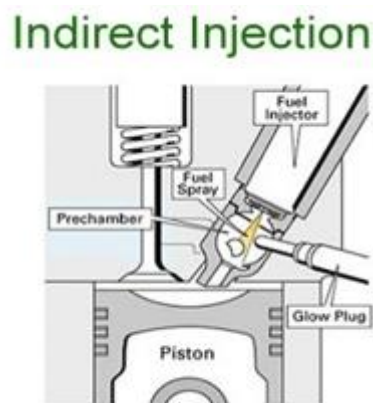
Gambar 2. 4 Indirect Injection (penyemprotan tidak langsung)
