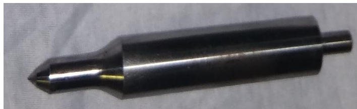
Gambar 4. 3 Jarum nozzle yang baik tanpa luka pada ujung jarum
