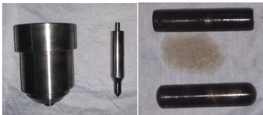
Gambar 4. 11 (kiri) Nozzle dan Jarum Nozzle, (kanan) Dowel pin Injector
