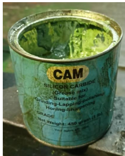
Gambar 4. 5 Grinding pasta yang digunakan crew engine kapal MT.Sindang untuk me-lapping permukaan Injektor dan Nozzle
