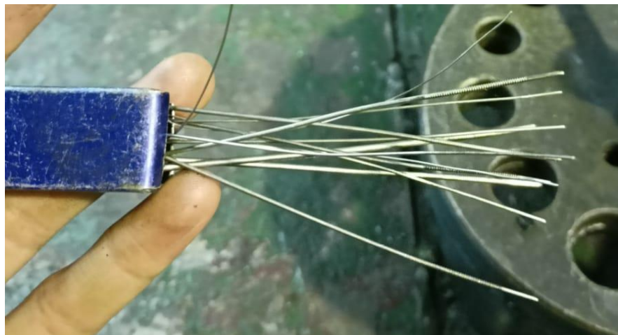
Gambar 4. 9 Alat pembersih Spray hole Injektor
