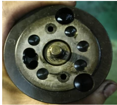
Gambar 4. 7 Permukaan Nozzle body yang mengalami kerusakan akibat aus
