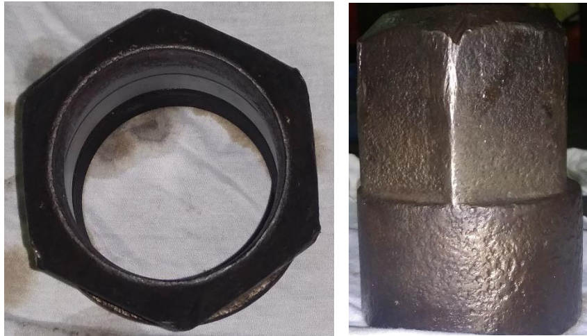
Gambar 4. 10 Mur pengikat antara badan Nozzle dan Nozzle Injektor
