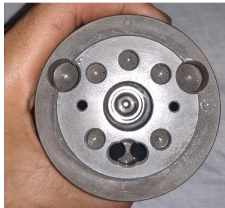
Gambar 4. 8 Gambar permukaan Injektor yang baik setelah di lapping
