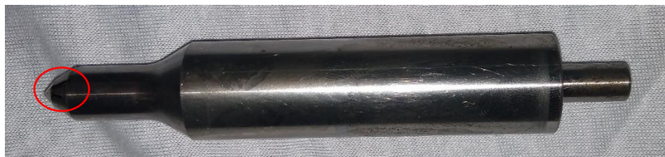
Gambar 4. 4 Jarum Injektor yang sudah tidak layak
