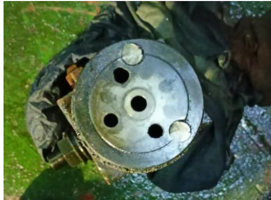
Gambar 4. 6 permukaan dari bada injektor yang mengalami kerusakan
