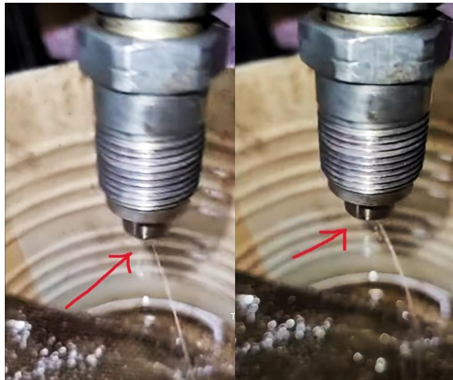
Gambar 4. 16 Contoh pengabutan yang tidak sempurna dari injector (menetes)
