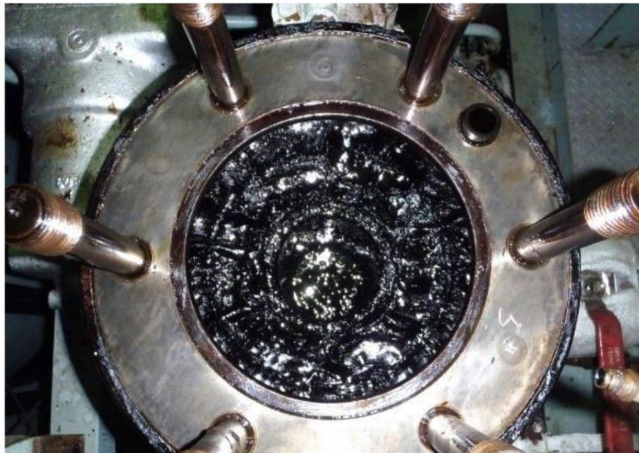
Gambar Kotoran yang menempel pada Delivery Valve
