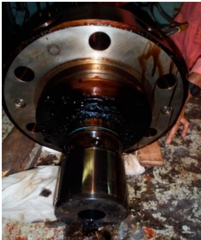
Gambar Kotoran yang menempel pada Plunger
