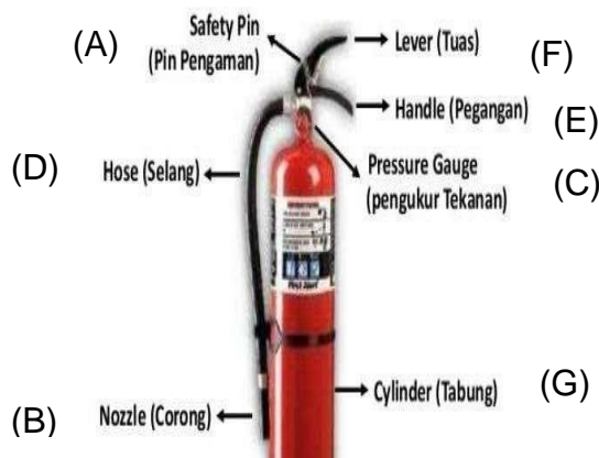
Gambar 2.4 Bagian-bagian Alat Pemadam Api Ringan
