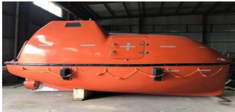
Gambar 2.7 Sekoci dibuat dari lingering Aluminium.
