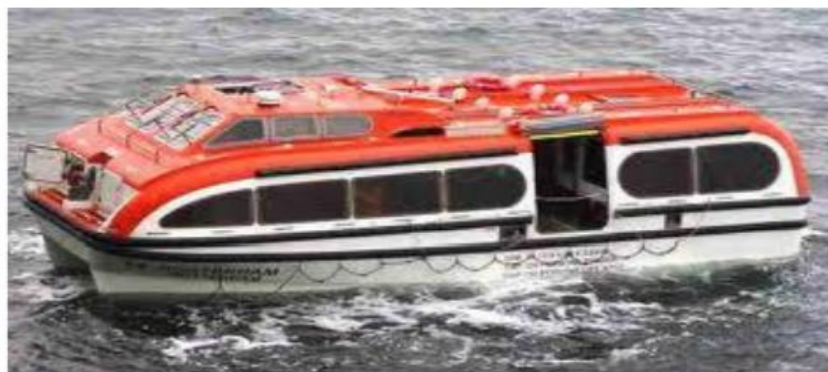
Gambar 2.6 Sekoci dibuat dari baja
