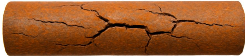
Gambar 2. 3 pipa korosi tegangan
