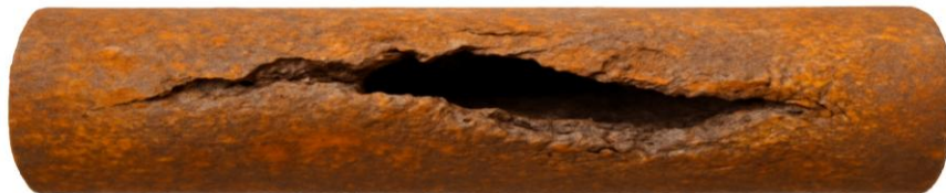
Gambar 2. 4 pipa korosi erosi
