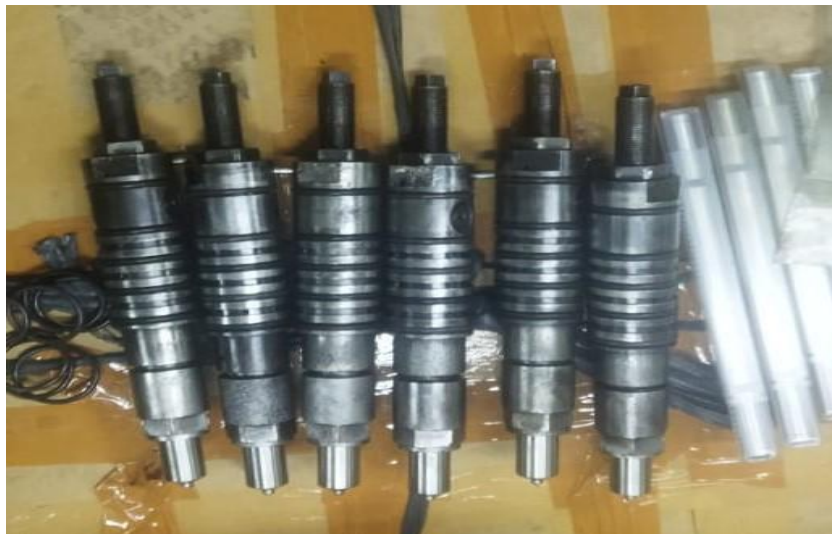
Gambar 2. 7 Injector MAK 8M20
