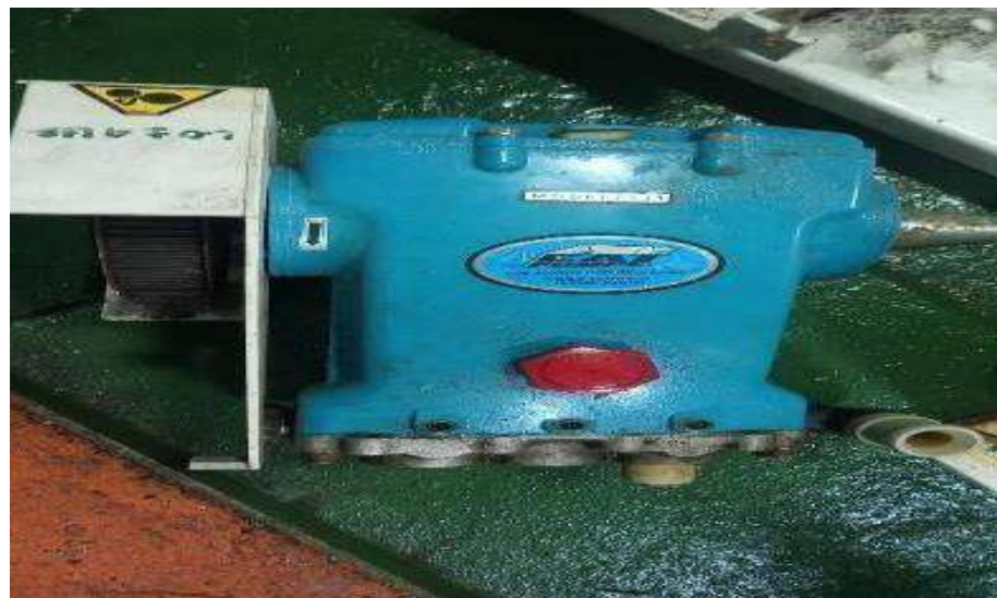
Gambar 2. 7 HP pump MT. Sengeti Sumber: Dokumentasi Pribadi MT. Sengeti
