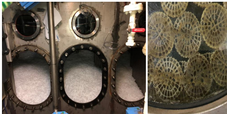
Gambar 2.7 Bioreactor Unit (kiri) Biofilm Plastic Carrier (kanan)
