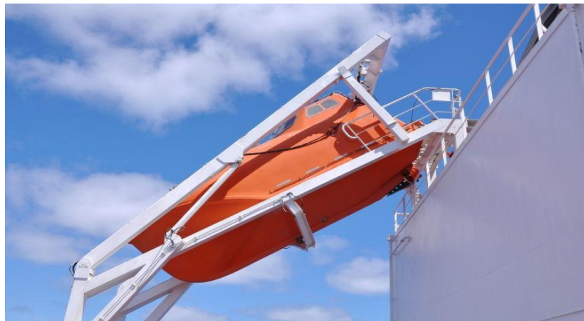
Gambar 2.3 Lifeboat Dengan Konsep Free Fall
