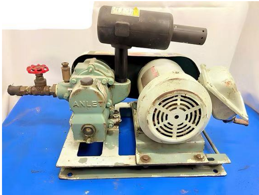
Gambar 2. 3 Blower Kompresor pada sewage
