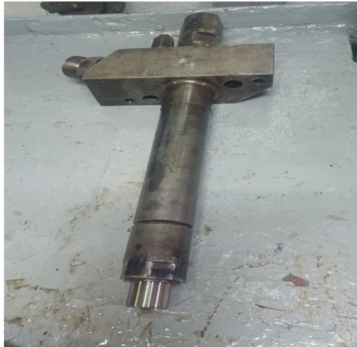
Gambar. 2.2 Injector pada kapal MT. Edricko 6 Sumber: Dokumentasi MT. Edricko 6 (2024)
