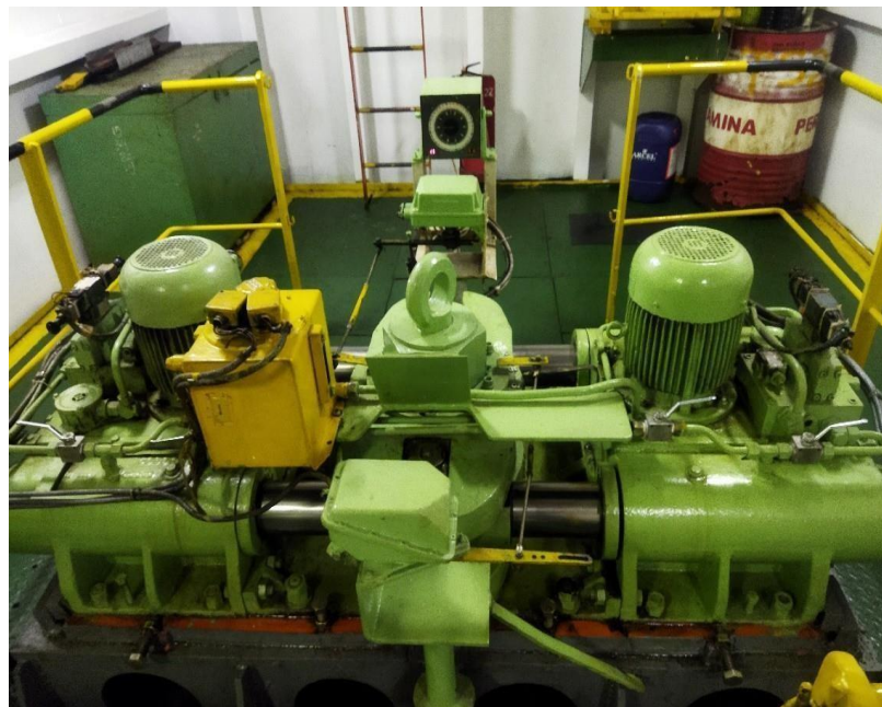
Gambar 2.1 : Sistem Hidrolik Steering Gear
