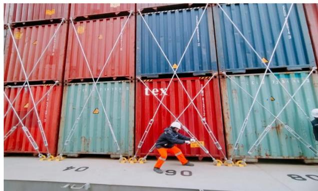
Gambar 2.1. Gambar Pola Pelashingan Kontainer On Deck
