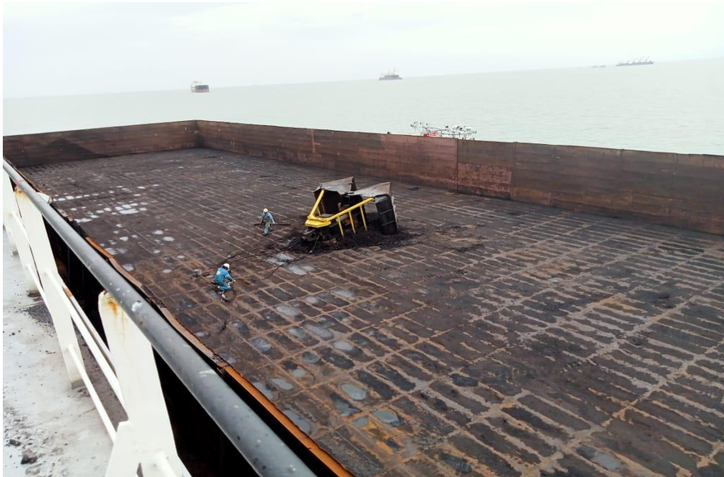
Gambar 4.7 Grab MV. Nord Kanmon yang Terjatuh ke Tongkang
