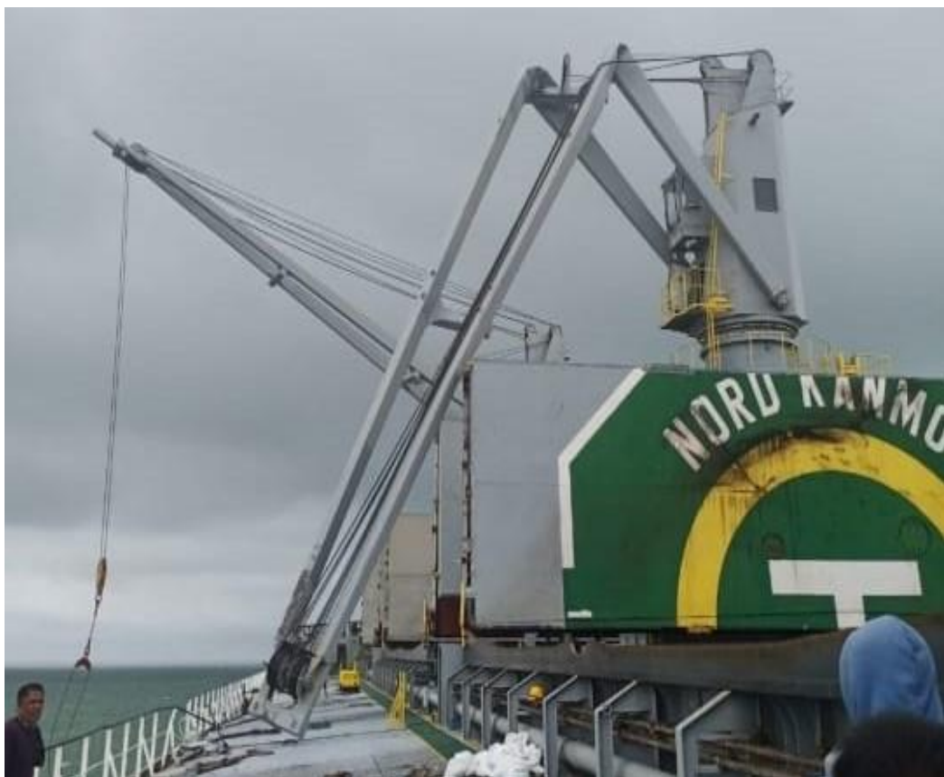
Gambar 4.6 Kondisi Crane Patah Pada MV. NORD KANMON
